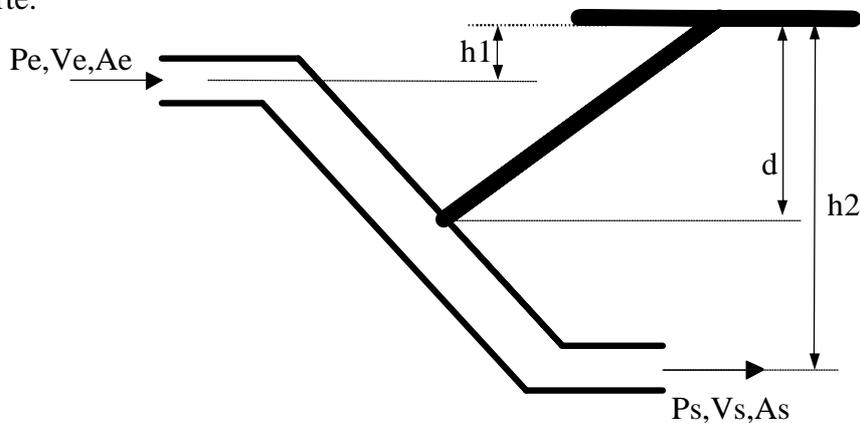
9.- En la figura se observa un cañón de riego, que impulsa una caudal  $Q_e$  de agua a 100 metros de distancia.
